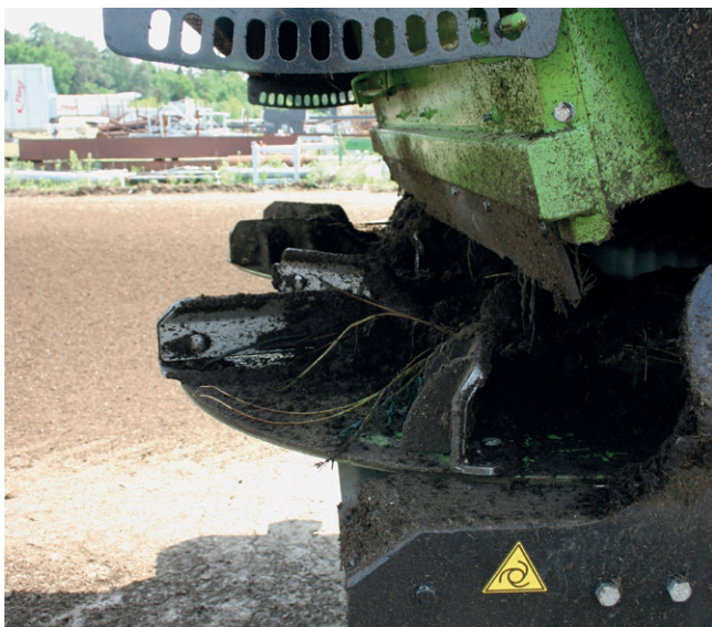
Рис. 6: Пластина с отверстиями для регулировки точки подачи удобрения
