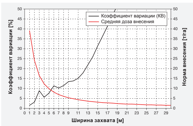
Рис. 11: Базовый и полный рисунок распределения компоста с нормой внесения 5 т/га
