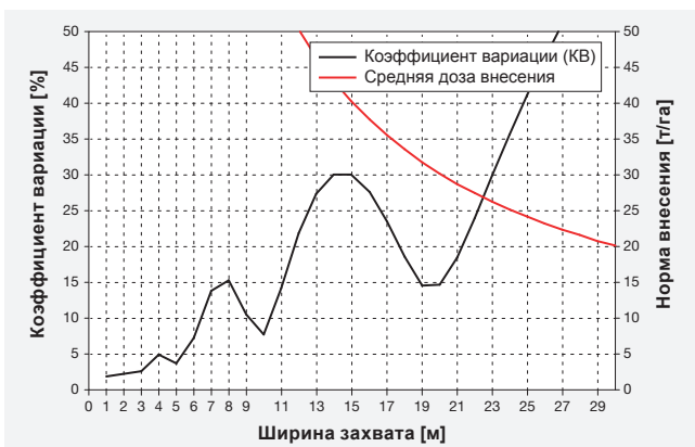
Рис. 19: Коэффициент вариации в зависимости от ширины захвата при внесении дигестата в количестве 5 т/га
