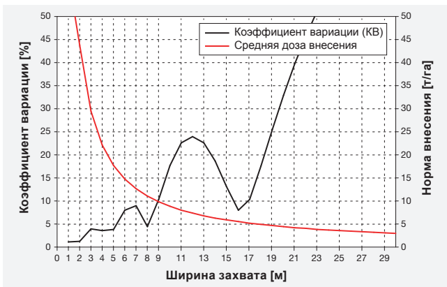
Рис. 18: Основной и общий уровень распределения дигестата при норме внесения 5 т/га
