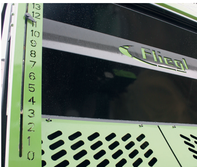
Рис. 5: Указатель размера выходного отверстия между грузовым пространством и разбрасывающим аппаратом на передней стенке разбрасывателя
