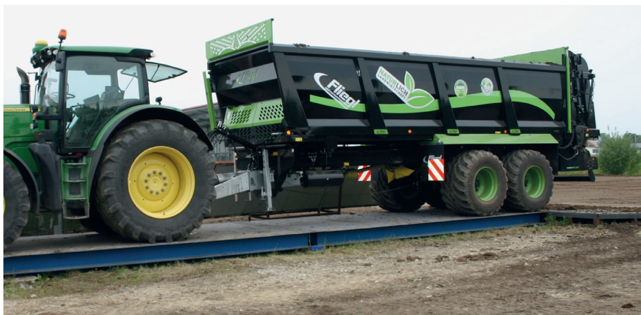
Рис. 3: Fliegl KDS 270 truck control на испытательном стенде для определения продольного распределения
