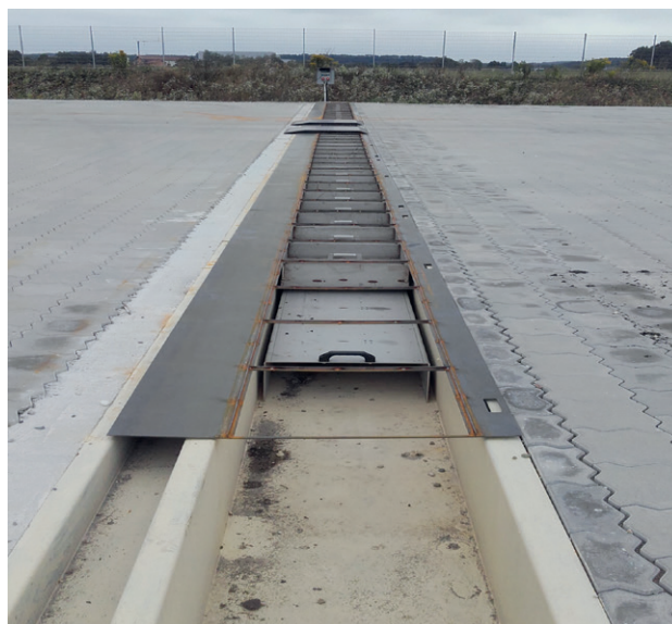
Рис. 2: Испытательный стенд для определения поперечного распределения
