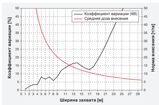
Рис. 7: Базовый и полный рисунок распределения навоза с нормой внесения 10 т/га
