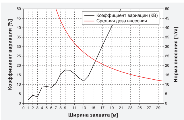
Рис. 12: Коэффициент вариации в зависимости от ширины захвата при внесении компоста в количестве 5 т/га
