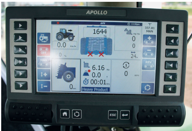
Рис. 4: Терминал управления разбрасывателя Fliegl KDS 270 muck control
