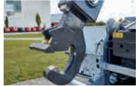
Geschmiedeter, einfach auswechselbarer Aufnahmehaken
