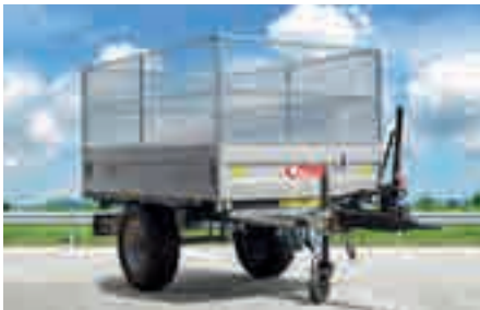
Superleicht: Der EDK 25 mit ALU-Bordwänden und Laubaufsatz
