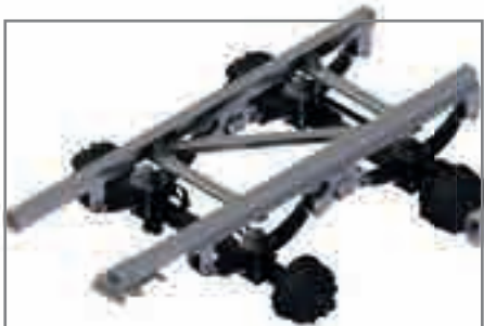
Gigant-Tandemaggregat (TMK 200 ab 5,65 m Muldenlänge)
