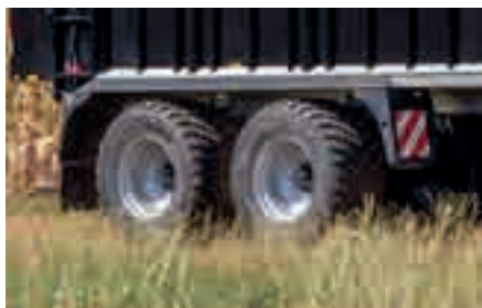
Bereifungsvarianten bis 800/45 R 22,5“ oder wahlweise 710/50 R 30,5“
