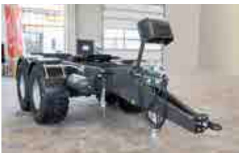
Tandem-Dolly mit 17 t Aufsattellast und 20 t Gesamtgewicht
