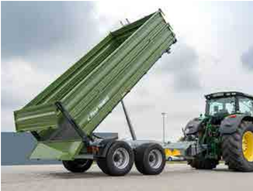
Schotterklappen Ausführung mit hydraulischer Heckklappe 500 mm.
