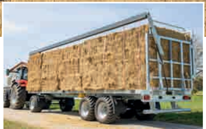
DPW 210 Ultra mit Ladungssicherung geschlossen, Öffnung wahlweise rechts oder links möglich.
