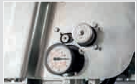
Mechanisches Potentiometer mit einstellbarer Vorschubgeschwindigkeit am Streuwerk
