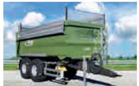
Verzinkter Aufbau, klappbar
