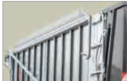
Aluminiumaufbau 300 mm seitlich
