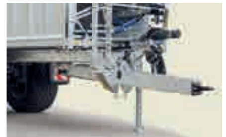
Durchgehend hydr. gefederte Zugeinrichtung für Untenanhängung
