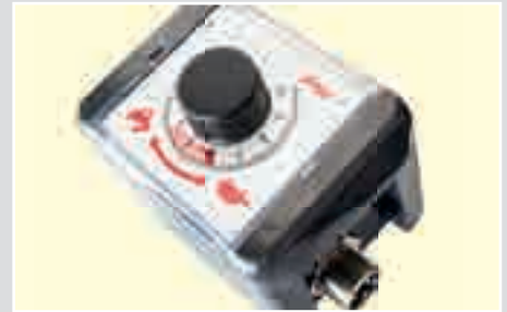
Elektrisches Potentiometer mit einstellbarer Vorschubgeschwindigkeit am Bedienpult
