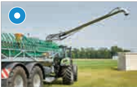
Nur für Pumpfässer: Absaugarm 8", Länge 5 m
