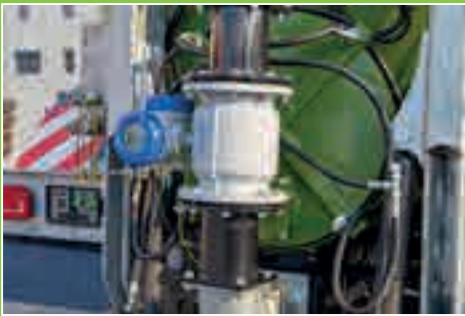
Die Durchflussmenge während der Ausbringung wird über den digitalen Durchflussmesser Optiflux 2300 der Firma Krohne induktiv gemessen.
