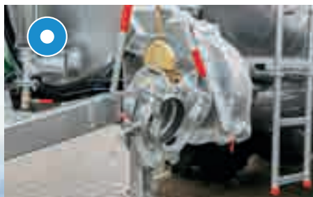
Nur bei Vakuumfass: Turbobefüller mit Schnellkuppler seitlich angebaut
