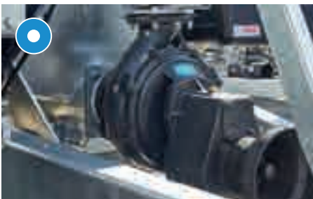
Kreiselpumpe zum Überladen
