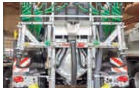
Zusätzliche Ausbringmöglichkeit mit angebautem Prallkopfverteiler
