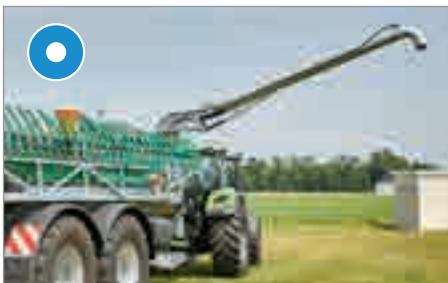
Nur für Pumpfässer: Absaugarm 8", Länge 5 m
