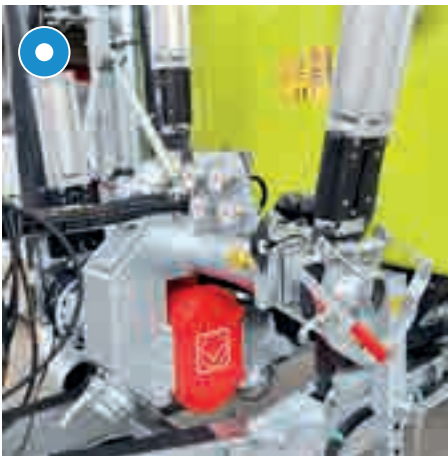
Drehkolbenpumpe »POLYFANT« mit hoher Wartungsfreundlichkeit
