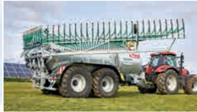
Keine abknickenden Auslaufschläuche durch speziellen Klappmechanismus
