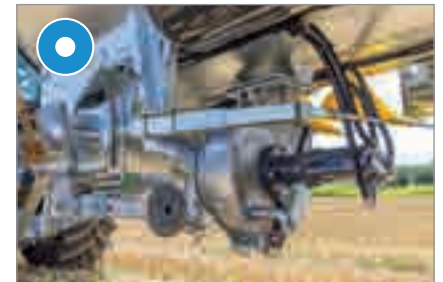
Bei Vakuumfass: Turbobefüller mittig unter dem Fass – für beidseitiges Ansaugen
