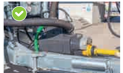
Hitzebeständiger Kompressor Optional: Wassergekühlter Kompressor
