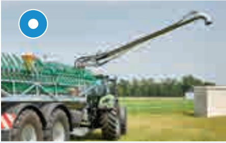
Nur für Pumpfässer: Absaugarm 8", Länge 5 m
