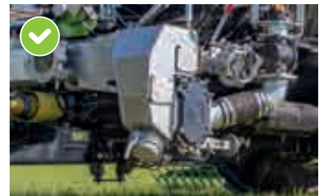
Äußerst wartungsfreundlich: Mechanisch angetriebene Drehkolbenpumpe inkl. Reduziergetriebe
