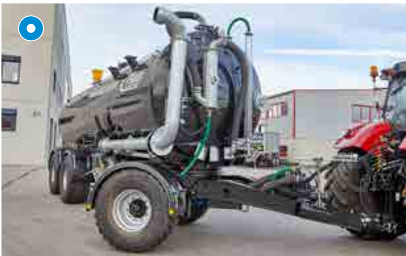
8" Saugrüssel für komfortables Ansaugen
