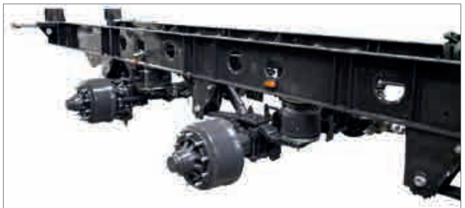
Spezielle Rahmenbauweise aus Feinkornstahl
