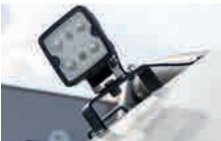
Arbeitscheinwerfer für Ausleuchtung des Verteilers
