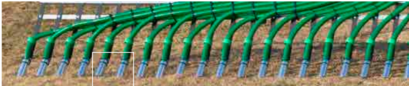
Schlitzkufenabstand von nur 187,5 mm
