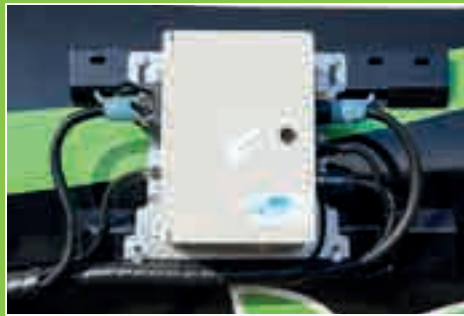
Schaltschrank FFC mit integriertem Jobrechner und ISOBUS-Schnittstelle
