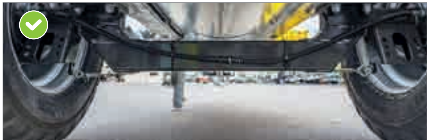
Gekröpfte Achse bei 5000 - 8.600 Liter Niedriger Schwerpunkt sorgt für optimales Fahrverhalten am Hang
