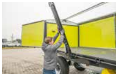
Odstranění středové klanice pro hladký průběh nakládky a vykládky
