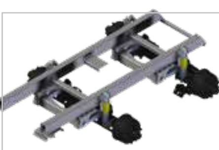
Hydraulické pružení náprav
