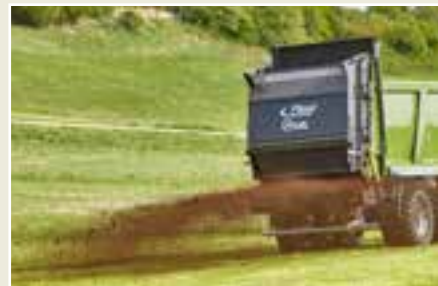
Talířový agregát k rozmetání do šířka varioSPLASH umožňuje rozmetání do šířky až 32 m.
