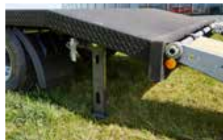
Podpěra zádi se 2 skládacími podpěrami
