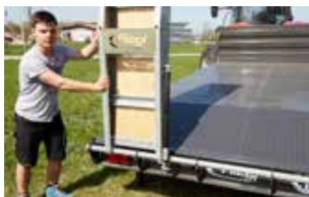
Praktické: Posuvné nájezdové segmenty k přizpůsobení rozchodu kol
