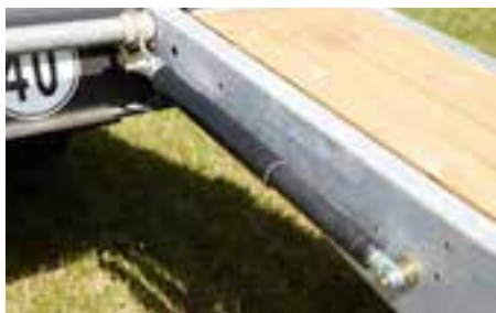
Nájezdová rampa sériově s pružnou pákou a volitelně také hydraulicky ovládaná
