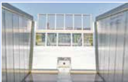
Těsnicí lišty: Nákladový prostor dokonale utěšňují polyuretanové lišty namontované speciálně pod úhlem 45°.
