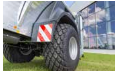
Volitelně: Provedení 40 km/h s blatníky u modelů ADS 80 / ADS100 / ADS120
