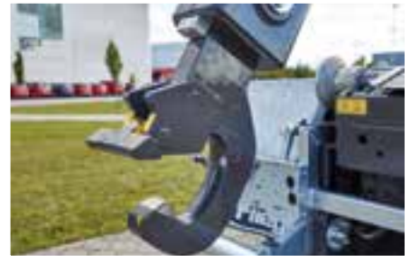
Kovaný, snadno vyměnitelný nosný hák
