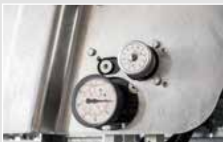
Mechanický potenciometr s nastavitelnou rychlostí posuvu na rozmetadle
