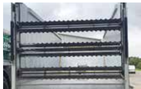
Dávkovací válec se 3 ležatými frézovacími válci
