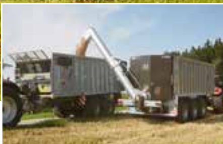
Překládací šnekový dopravník ÜLS 400 na obilí Výkon překládání cca 7,5 t/min
