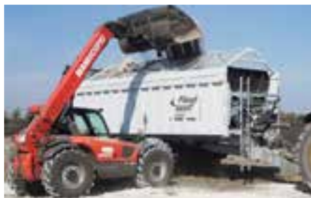
ASW 373 Tiger s ochrannou mříží proti cizím tělesům
