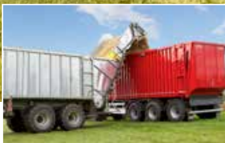
Překládací pás »MobilFast« (až 30 m 3 /min)
