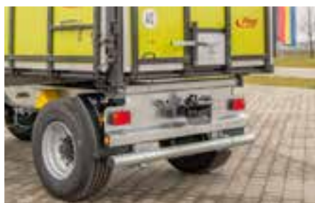
Držák osvětlení s automatickým tažným zařízením a okénkem na obilí
