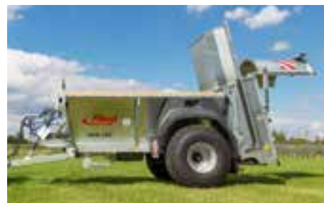
Hydraulická akumuláční klapka (Gilotina)
