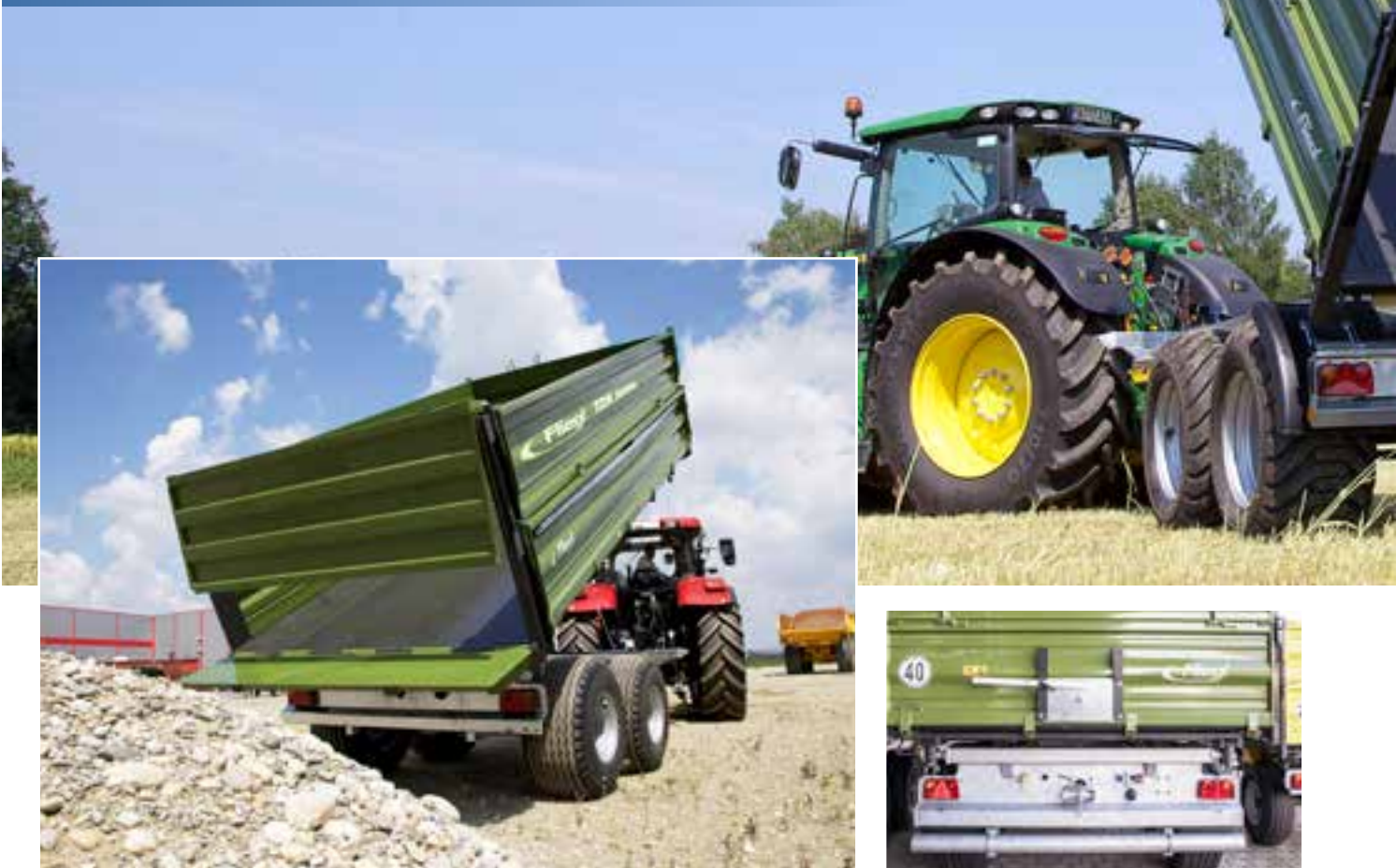
TDK 160 s hydraulickou šterkovou klapkou 500 mm Korba z oceli 450 HB odolávající opotřebení, rohové sloupky svařované. Korba: 5000 × 2320 × 2220 mm
