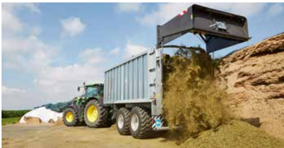
Dávkovací válec se 3 ležatými frézovacími válci
