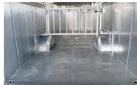
Slzičkový plech zajišťuje bezpečné stání zvířat
