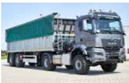
TOPLIFT LIGHT: Krycí síť lze po stranách sklopit
