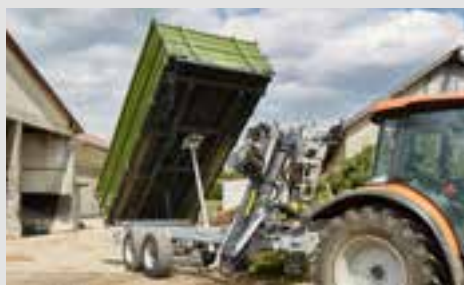
TDK-K 110 s hydraulickou rukou Z typ Z60
