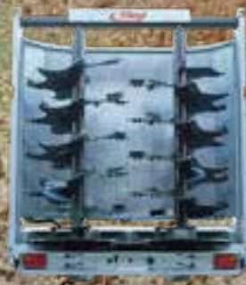
Frézovací válec s vyhazovacími lopatkami
