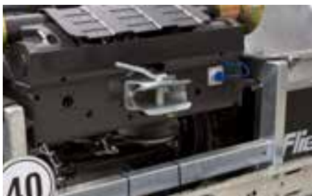
Volitelně: Nosič osvětlení s možností vytažení, brzdová přípojka a hydraulika pro 2. přívěs
