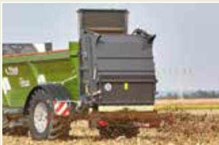
Talířový agregát k rozmetání do šířka varioSPLASH umožňuje rozmetání do šířky až 32 m.
