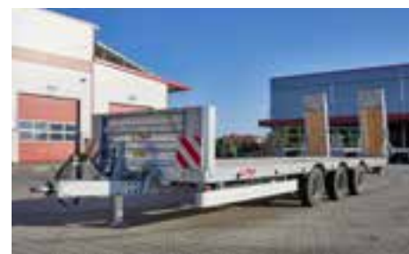
TPA 370 Čelní stěna 800 mm v sériové výbavě Nájezdová rampa sklopná
