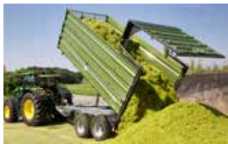
Silážní sklápěč s hydraulickou zadní stěnou
