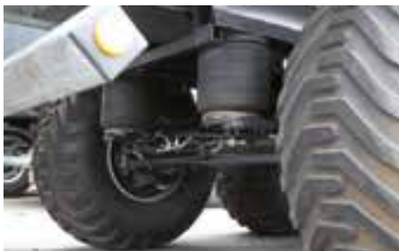
Volitelně: Vzduchové odpružení s automatickým spouštěním při sklápění
