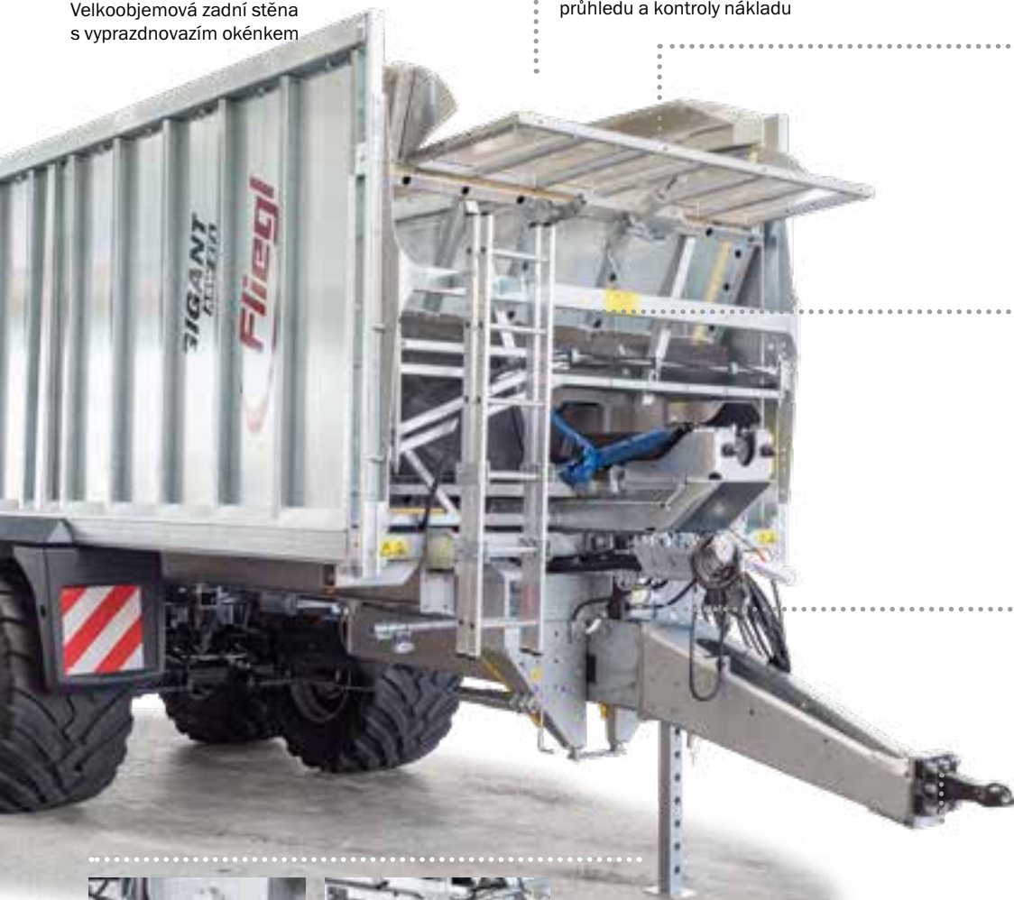
Provedení vyhrnovacího čela "Insight" vyrobené z materiálu odolného proti nárazu k zlepšení průhledu a kontroly nákladu
