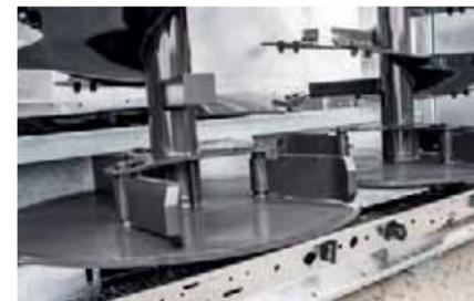
Durch die bewährte Fliegl Abschiebeteknik wird das Material gleichmäßig dem Streuwerk zugeführt. Nach dem Streuen ist der Laderaum nahezu sauber, der Unterboden bleibt im Gegensatz zum herkömmlichen Kratzboden sauber.
