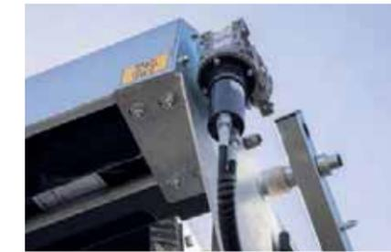
Schutzvorrichtung gegen Verschmutzung und Beschädigung
