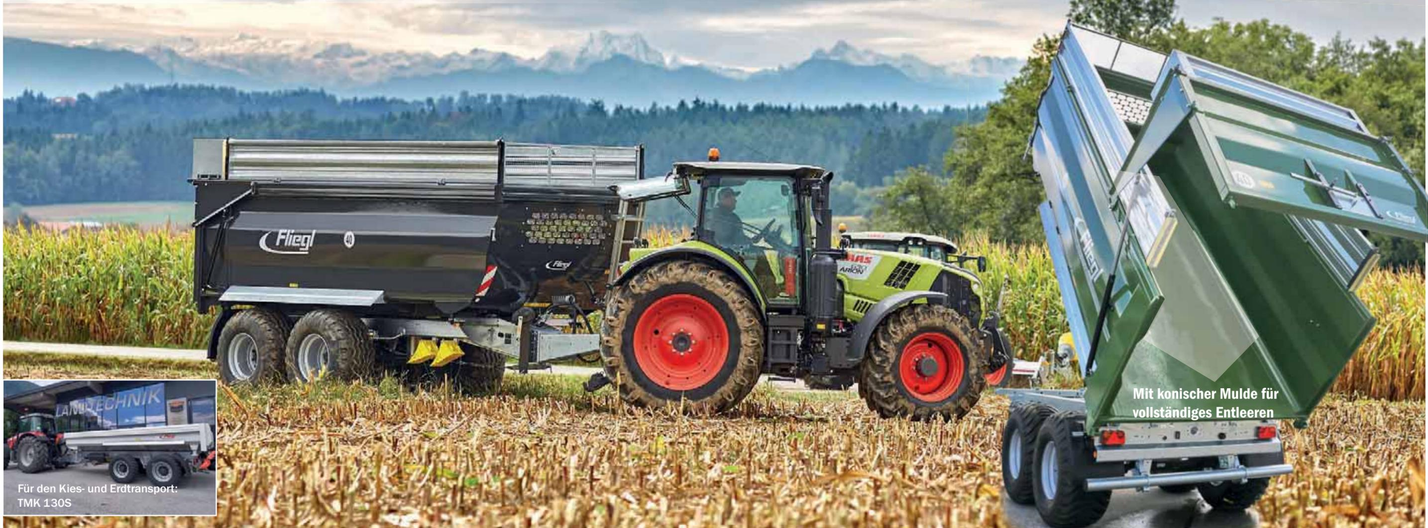
Mit konischer Mulde für vollständiges Entleeren
