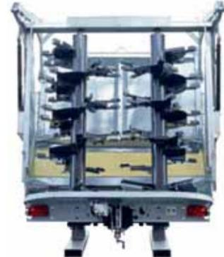
Fräswalzen mit Wurfschaufeln
