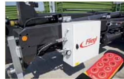
Steuerung mit Funkfernbedienung (optional)
