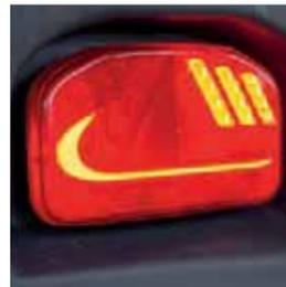
Voll-LED Rückleuchte „Dynamic“ mit dynamischer Blinkerfunktion aus schlagfestem Material
