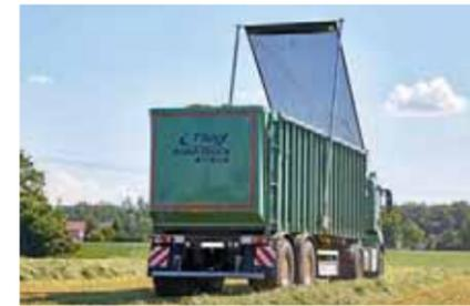
Aufziehen durch Federspannung
