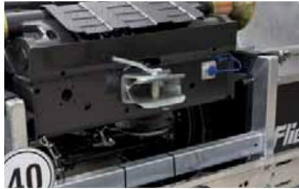
Optional: Bremsanschluß und Hydraulik für 2. Anhänger
