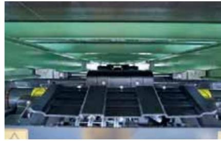
Optional: Hydraulische Abstützung auf die Achse
