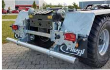
Optional: Ausziehbarer Beleuchtungsträger
