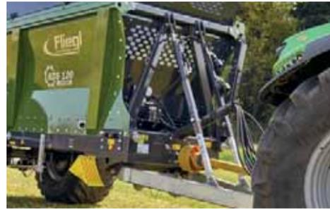
**Hydraulisch gefederte Zugdeichsel für Tiefbettstreuer / Untenanhängung.**
