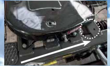
Mechanische Sattelplattenverstellung für Einachs- und Tandem-Dolly
