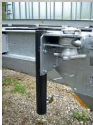
Zylinder für hydraulische Hebeeinrichtung
