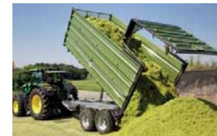
Silierkipper mit hydraulischer Rückwand
