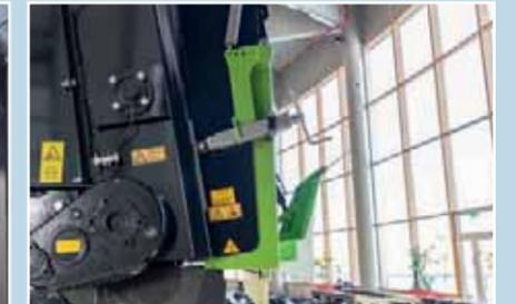
Das Tellerstreuwerk **varioSPLASH** besitzt zwei große Streuteller mit 1100 mm Ø und je 6 quer zum Wurfwinkel verstellbaren Wurfblügeln. Sie sind mit auswechselbaren Platten aus HB 400 bestückt und können durch Sicherungsbolzen in ihrer Sensibilität verändert werden. Beim Tandem und Tridem ist der Winkel des Streutisches mechanisch oder optional hydraulisch verstellbar.
