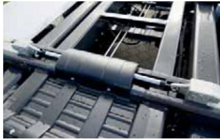
Umsteckbares Verriegelungssystem für Innen- und Aussenverriegelung
