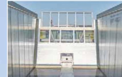
Dichtleisten: Die speziell im 45° Winkel angeordneten Polyeteranleisten im dichten den Laderaum perfekt ab.
