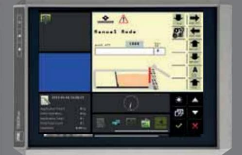
Das ISOBUS Multi-Control ist eine Multi-Maschinensteuerung. Es erlaubt das parallele Verwenden von FLIEGL VARIO SENS und z.B. FLIEGL TRAILER CONTROL. Das Multi-Control vereinfacht somit die Arbeit des Nutzers und steigert außerdem die Effizienz der Anwendung an sich.
