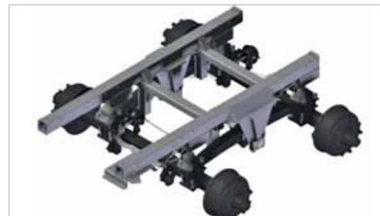
Titan-Tandemaggregat für besten Bodenausgleich, schmierlos und wartungsfrei.
