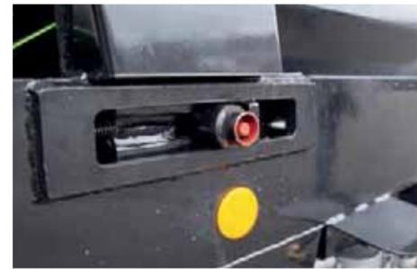
Bequem zugänglich und beidseitig durch die Welle **schmierbare Kettenräder**
