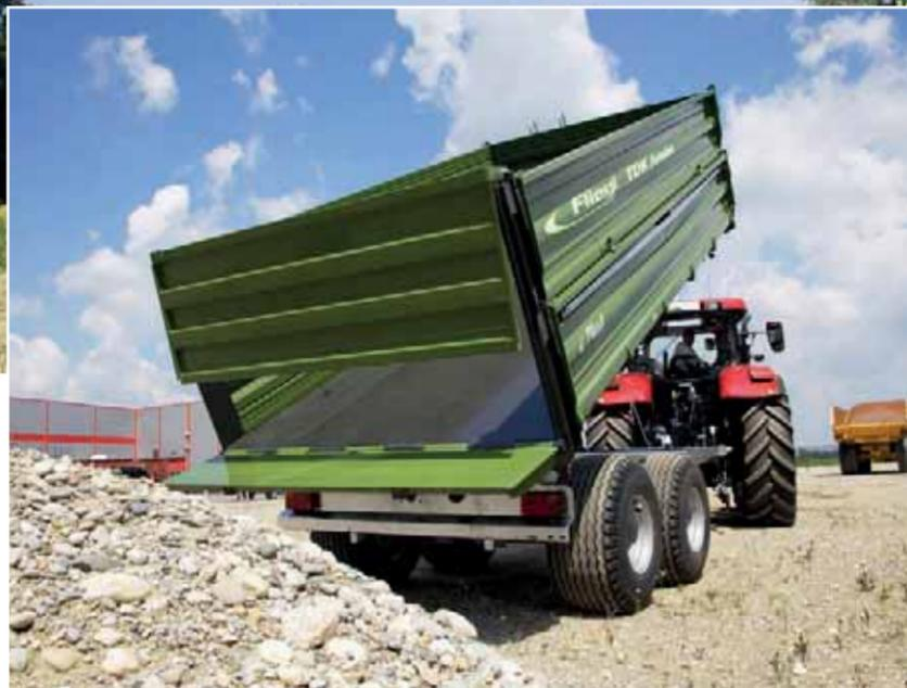
TDK 160 mit hydr. Schotterklappe 500 mm | Brücke aus verschleißfestem Stahl 450 HB, Eckrungen verschweißt. Brücke: 5000 x 2320 x 2220 mm
