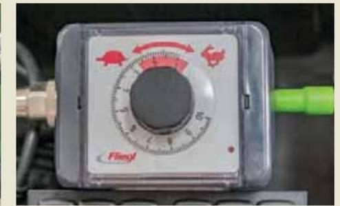
**Elektrisches Potentiometer** mit einstellbarer Vorschubgeschwindigkeit am Bedienpult
