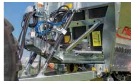
Hydraulische Deichselfederung, bester Fahrkomfort
