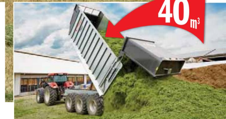
Höchste Standsicherheit beim Kippen durch geringen hinteren Überstand der Mulde hin zur Achsmittle sowie der hydraulisch betätigten Großraumrückwand, die beim Öffnen in Richtung Achsmittle schwenkt.
