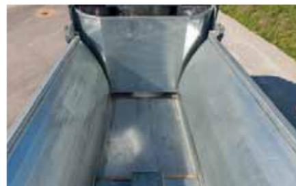
Geringster Verschleiß durch hydr. Schiebesystem – kein Kratzboden
