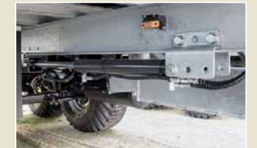
Die stufenlos hydraulische Achsverschiebung
