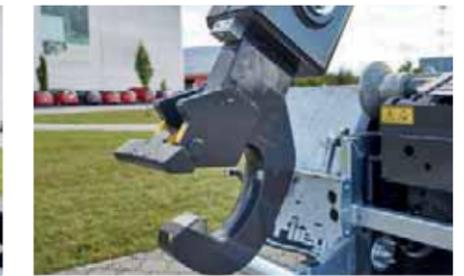
Geschmiedeter, einfach auswechselbarer Aufnahmehaken
