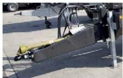
Drehbarer Zugholm für Oben- und Untenanhängung
