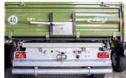
40 km/h Ausführung mit Unterfahrschutz und Kotflügel
