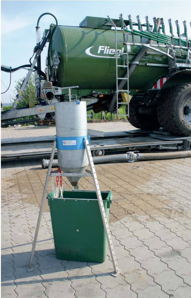
Bild 8: Fluidmeter zur Bestimmung der Fließfähigkeit von Flüssigmist
