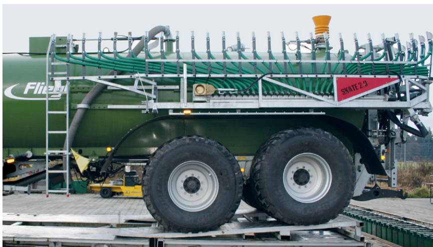
Bild 14: FLIEGL Schneckenverteiler am Schleppschuhgestänge FLIEGL SKATE 150 mit hydraulisch zu öffnendem Messingschieber zur Entleerung des Staukastens
