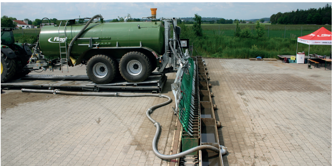
Bild 7: Prüfstand zur Ermittlung der Querverteilung
